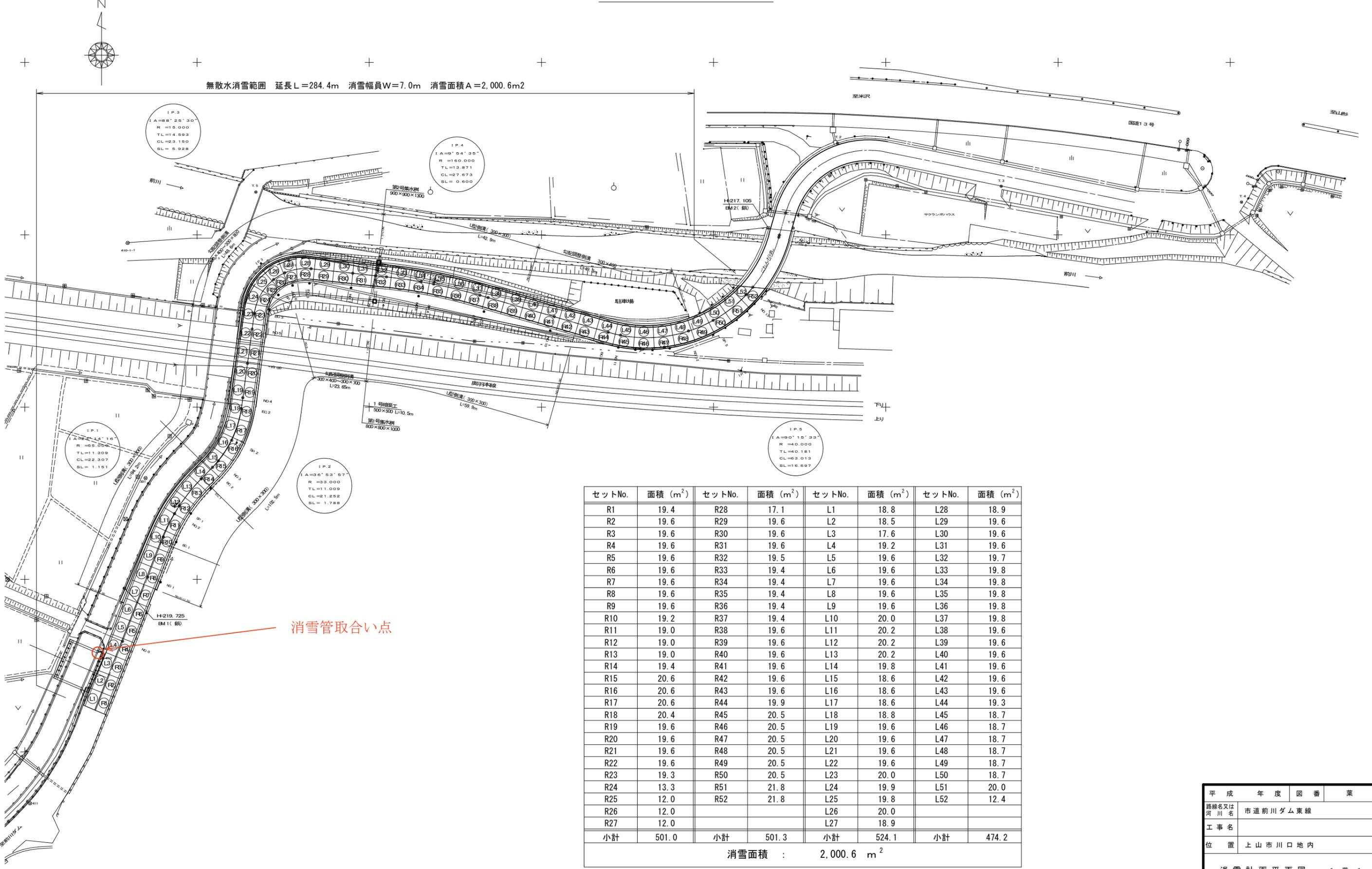
無散水消雪範囲 延長L=284.4m 消雪幅員W=7.0m 消雪面積A=2,000.6m<sup>2</sup>
